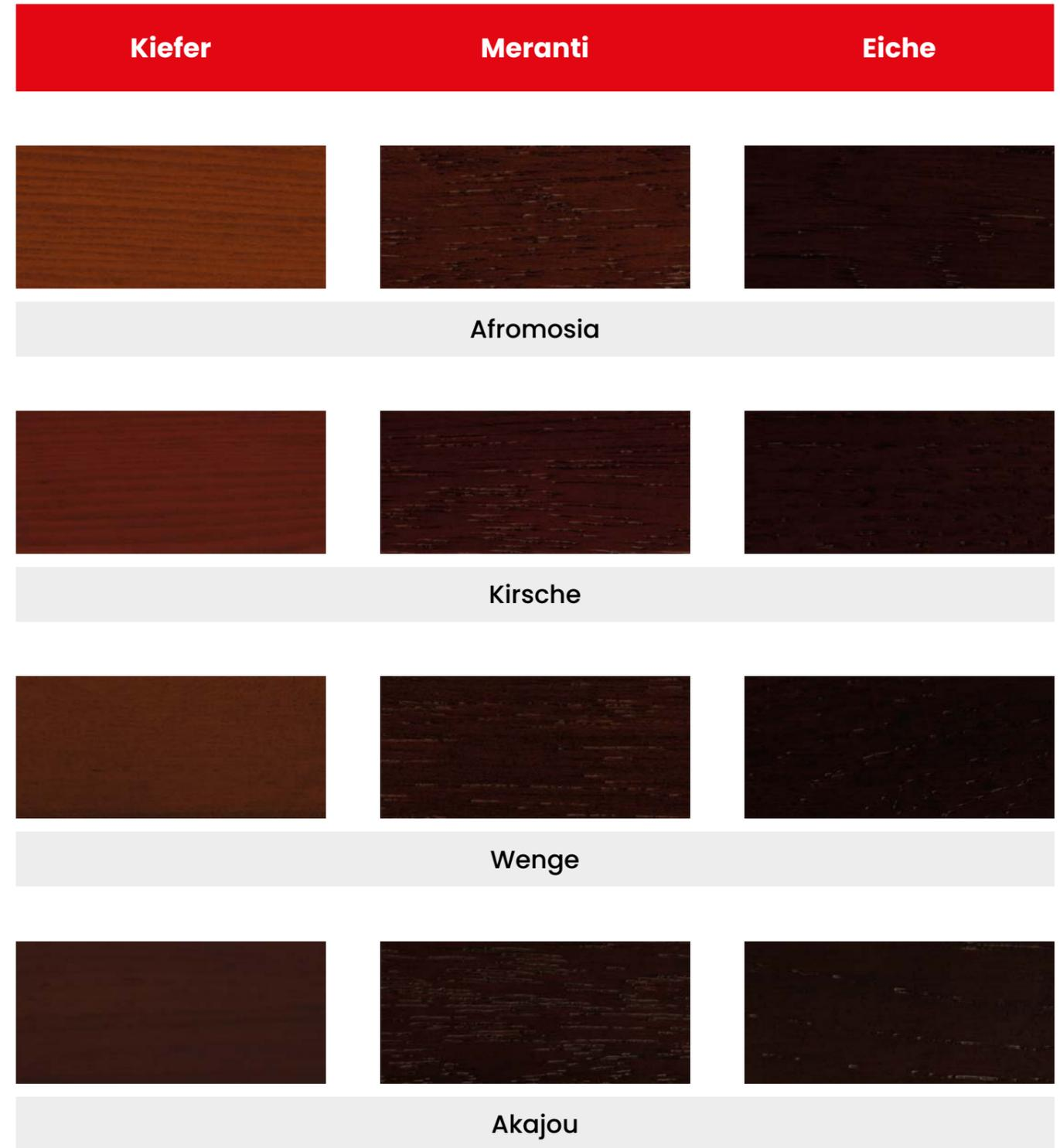
**HINWEIS!** Wir möchten Sie darauf hinweisen, dass die Holzoberfläche nach einer Imprägnierung mit einer Dünnschichtlasur auf den einzelnen Elementen unterschiedliche Farbtöne aufweisen kann. Bei der Holzart Meranti ist dieser Effekt besonders sichtbar. Bei Kiefer keilgezinkt bleiben die Keilzinkenverbindungen sichtbar.
