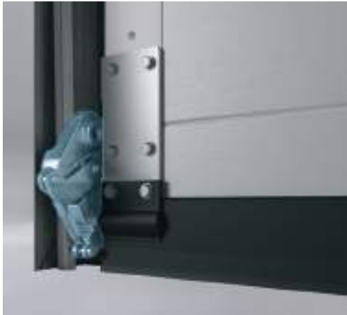
Sicherheitsbremse, die das Herabfallen des Torflügels bei Seilbruch verhindert
