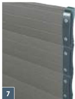
**Kunststoff-Elemente** – gewährleisten den Abstand zwischen den Profilen beim Aufrollen des Torbehangs, so dass das Tor leise ist und die Lebensdauer des Tores deutlich verlängert wird.
